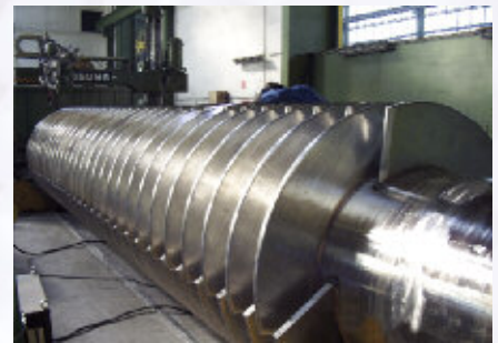
Rotor für einen Terephthalsäure-Trockner
