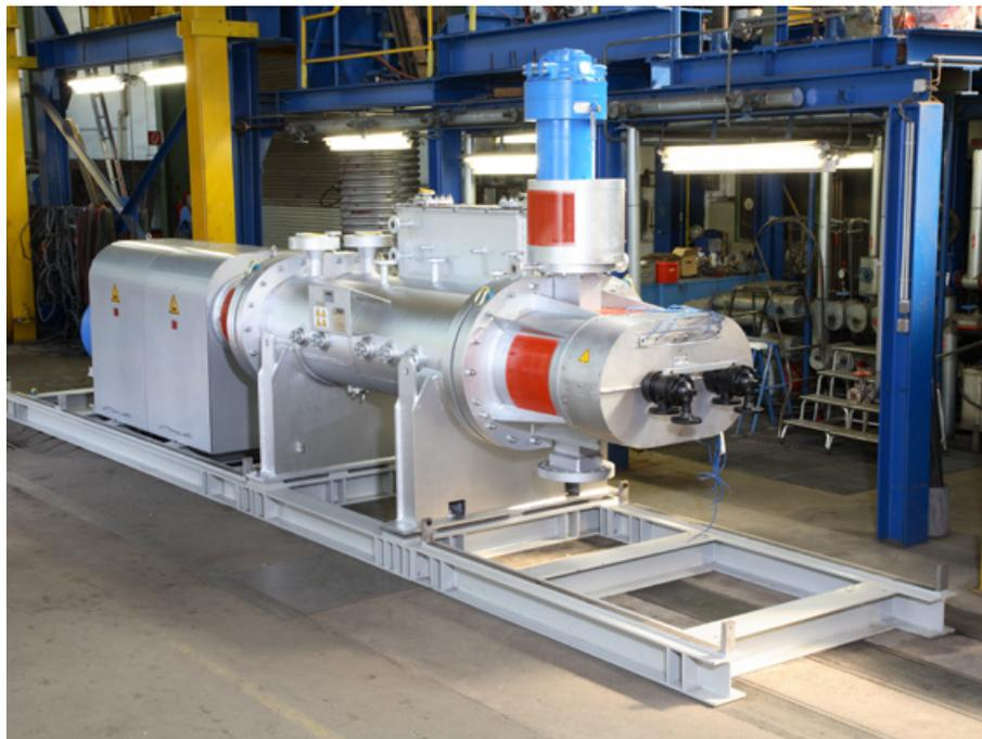
Die vielseitig einsetzbaren Reaktoren zeichnen sich durch sehr große Prozessvolumina und hervorragende Selbstreinigung aus. Die beiden gleichsinnig drehenden Rotoren des Reacom und die gegensinnig laufenden Rotoren des Reasil ermöglichen die Pfropfenströmung des viskosen Produktes. Die gute Selbstreinigung wird durch das Ineinandergreifen der speziell geformten Rotorelemente erreicht. Die Rotoren und Gehäuse der beiden Prozessoren können beheizt oder gekühlt werden.
