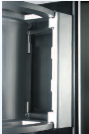
Rotor mit pendelnd aufgehängten Wischerblättern aus Metall.
