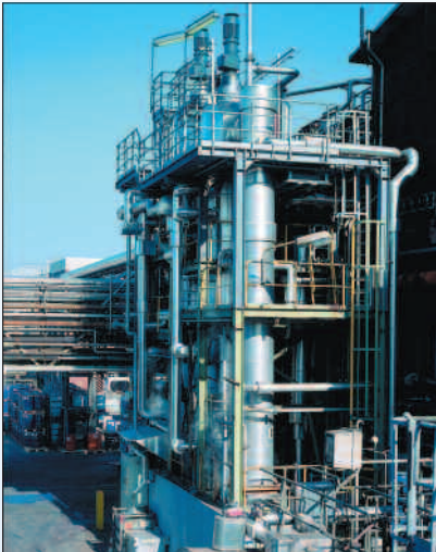
2-stufige Dünnschichtverdampferanlage zur Harzkonzentrierung.
