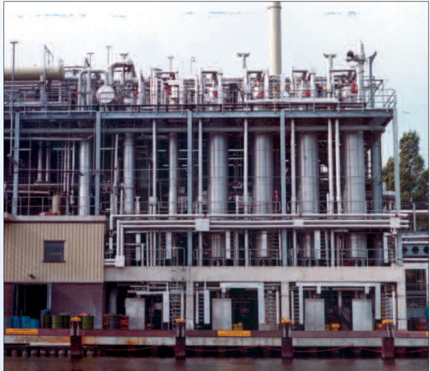
Mehrstufige Fallfilmverdampferanlage für Miscella-Destillation.
