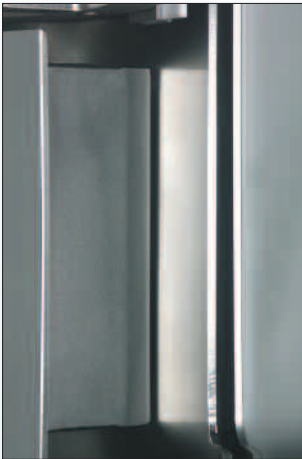
Starrflügelrotor mit definiertem Filmspalt.
