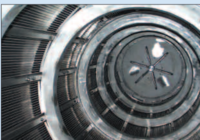
Kurzwegverdampfer-Rotor mit Spritzerschutz.
