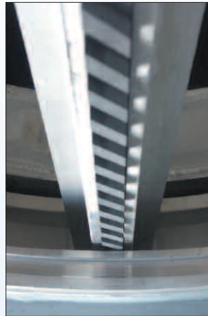
Rotor mit radial beweglichen Wischerelementen aus PTFE oder Graphit.
