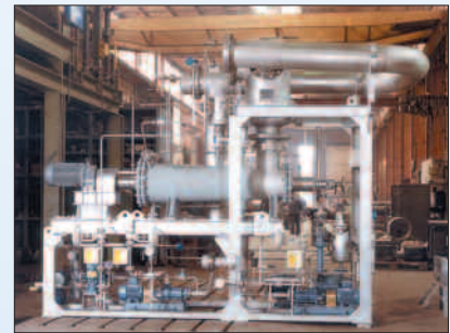
Verdampfermodul mit SAKO® KH.
