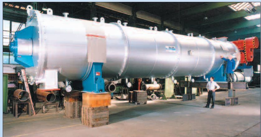
Horizontaler Dünnschichttrockner zur Schlammtrocknung
