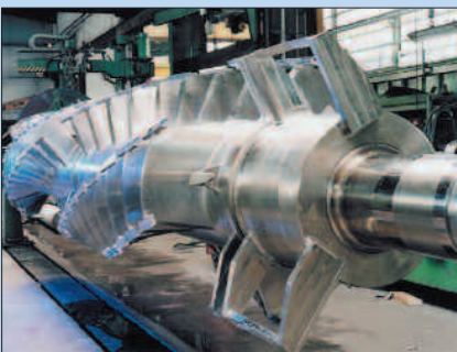
Rotor eines Konti-REACTOTHERM®
