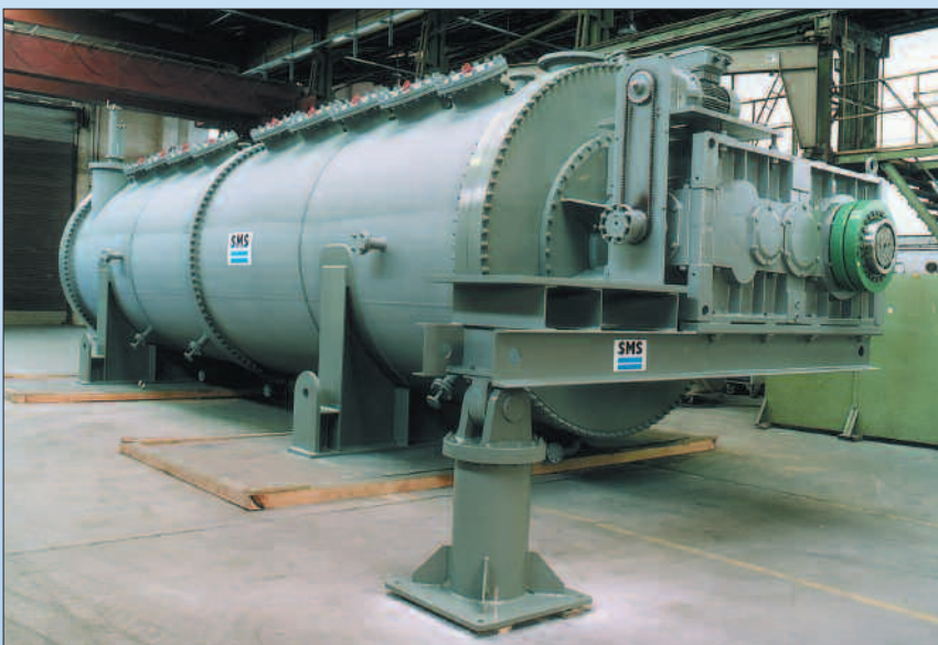
Großer ROVACTOR® für die Trocknung lösungsmittelfeuchter Kunststoffe
