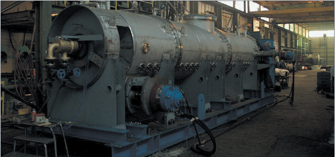
Reactotherm® mit hydraulischen Hochmomentantrieben für Rotor, Side-Feeder und Austragsschnecke. Das Bild zeigt den Reactotherm® während der Abnahme in unserem Werk vor der anschließenden Reinigung und Vorbereitung zum Transport.
